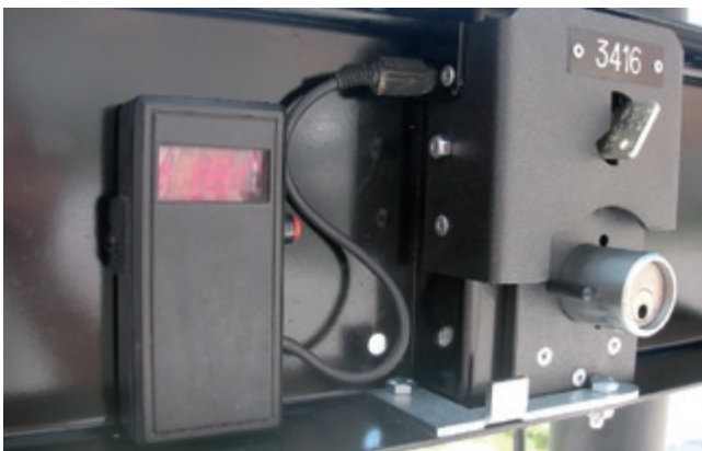
Abbildung 8: Italienisches FVS mit mechanischem Schloss am Abstellplatz in Teramo (Foto: C'entro in bici)
