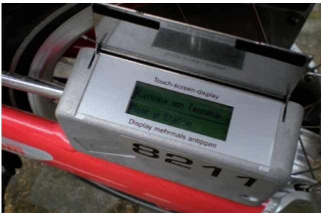
Abbildung 7: Elektronisches Call a Bike Code-Schloss (Alberto Castro Fernandez, TUW)
