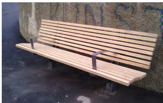
Figure 1 Le banc « Lausanne » est adapté aux besoins des personnes à mobilité réduite. Il est muni d'accoudoirs et la hauteur d'assise (45cm) aide à se relever.
