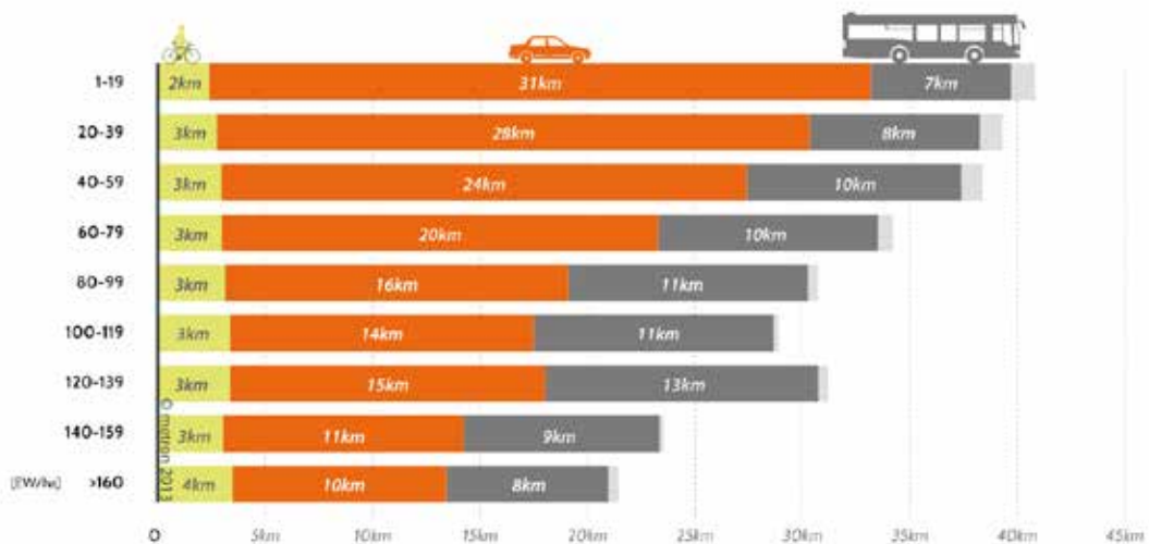
Abbildung 4 Wegdistanz nach Dichte-Kategorie: Basis Inlandwege (Routingdistanz) und mittlere Einwohnerdichte im Umkreis von 300m
