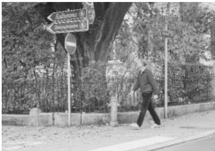
Wegweiser speziell für Fussgänger sind notwendig, wenn der Fahrverkehr – z.B. infolge Einbahnregelung – auf anderen Routen geführt wird.
