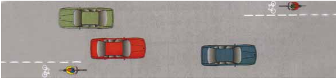
Prinzipskizze zum realisierten „alternierenden Schutzstreifen“ (Quelle: ENGELS 2003)
