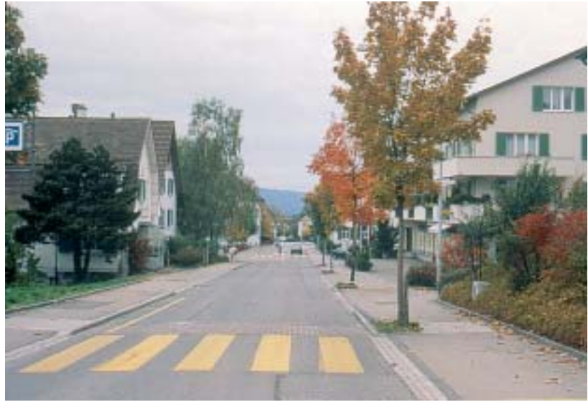
Baumreihe in Gehweg integriert, geschützte Fussgängerübergänge
