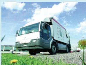
Durch die utechag mit SCR und Partikelfilter ausgerüstetes Kehrmaschine der Stadt Bern.
