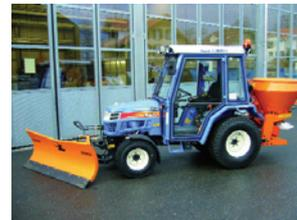
*Der Kleintraktor zur Schneeräumung der Stadt Thun ist mit einem geschlossenen Partikelfiltersystem ausgerüstet.*
