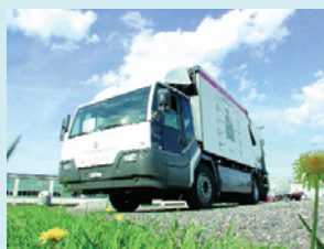
Camion à ordures de la ville de Berne équipé par utechag de la technologie SCR et d'un filtre à particules.
