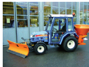
Ce petit tracteur pour le déneigement de la ville de Thounne est équipé d'un système de filtre à particules fermé.
