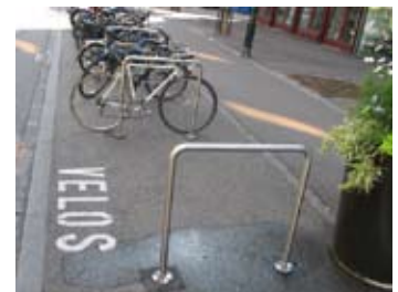
Les poteaux et les arceaux permettent d'appuyer le cycle et de le verrouiller par le cadre.
