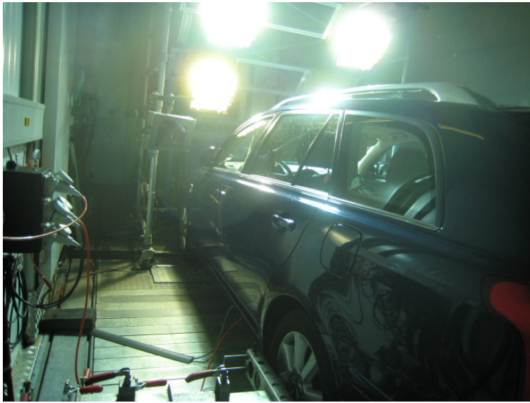
Figure 3: Une voiture sur le banc d'essai climatique de l'Empa, en cours de test à température, humidité et rayonnement solaire élevés.
