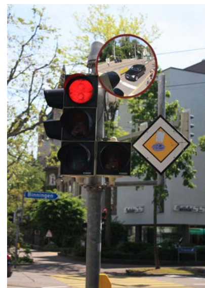
Passage dangereux : carrefour équipé d'un miroir Trixi
