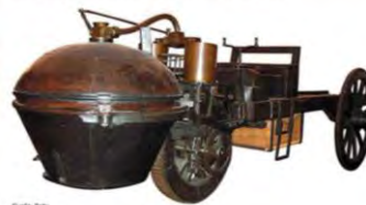
Dampfswagen von Nicholas Cugnot, zweite Version, 1771
