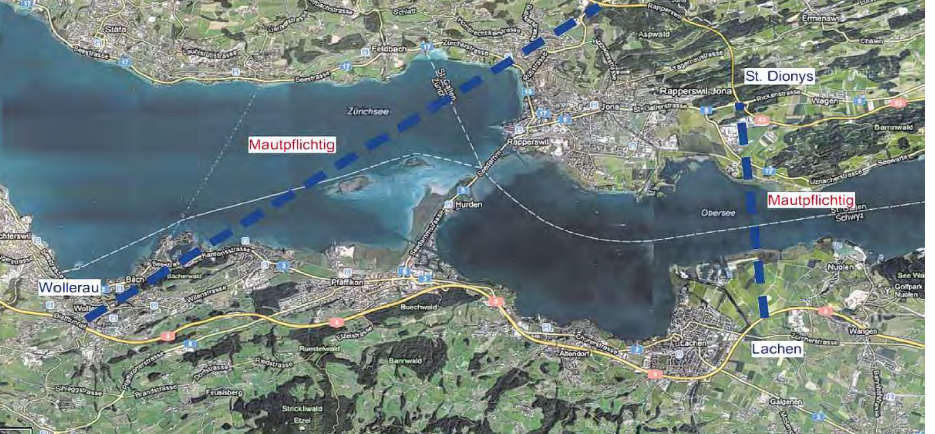
Uten durch: Die Lösungsfamilie 2 sieht Tunnel unter dem Zürichsee vor - bis unten die Autobahnen A53 und A3 verbinden. Quelle: www.rotopico.com
