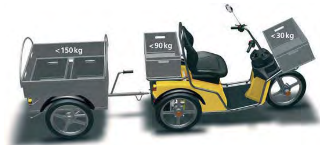
Abbildung 12: Der Kyburz DXP mit den zulässigen Nutzlasten. (Foto Kyburz)
