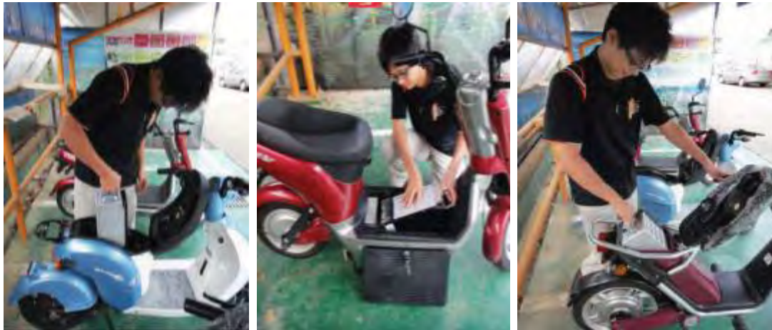
Abbildung 30: Drei mögliche Arten, die Einheitsbatterie im Fahrzeug unterzubringen. (Foto: ITRI)
