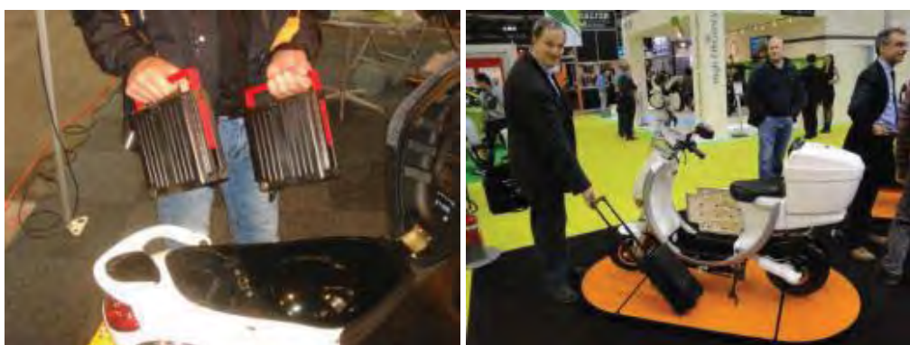
Abbildung 28: Zwei abnehmbare Li-Ion-Batteriepakete des PGO e-wave (links) und das als Rollenkoffer ausgebildete Batteriepaket des e-max 80L. (Foto Urs Schwegler)
