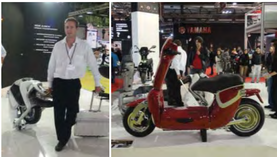
Abbildung 29: Gefaltetes Fahrzeug und Batterie von XOR als zwei Rollenkoffer, rechts das Fahrzeug im Fahrzustand. (Foto Urs Schwegler)
