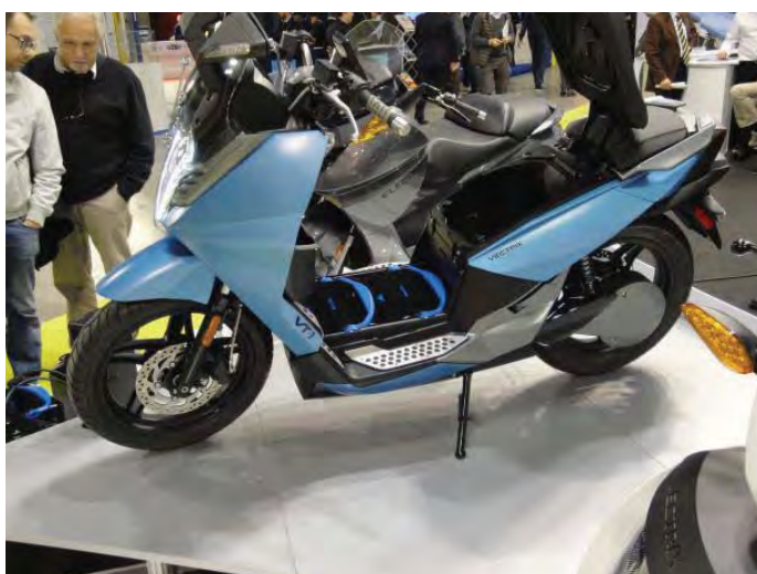
Abbildung 11: Der für 2014 angekündigte Vectrix VT1 mit den herausnehmbaren Batteriemodulen. (Foto Urs Schwegler)
