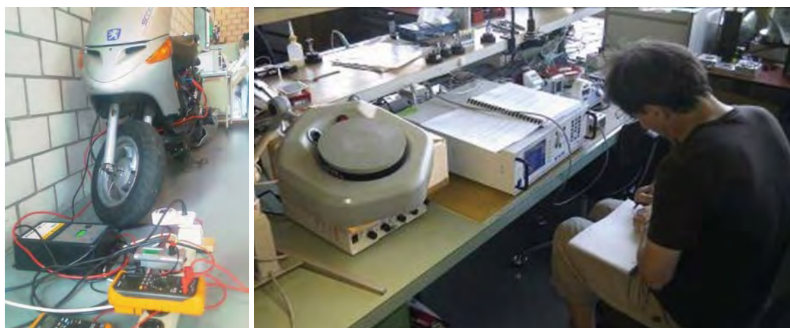
Abbildung 61: Messaufbau und Messvorgang an den ausgewählten Stromkostenmessgeräten. (Bilder: Empa)
