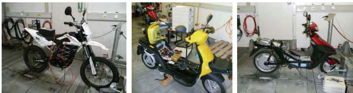
Abbildung 46: E-Scooters auf dem Empa Rollenprüfstand. Von links nach rechts Quantya ‚Evo 1‘; Oxygen ‚Postscooter‘; Mobilec ‚Mobilec‘. (Bilder: Empa)
