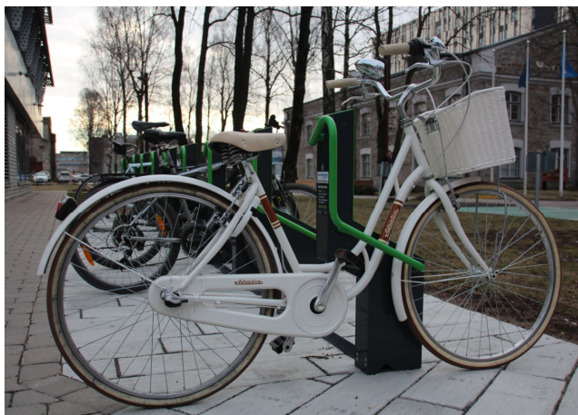
Das Fahrrad ist nun um Rahmen und Vorderrad diebstahlsicher verriegelt
