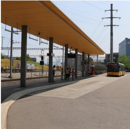
Ist keine gerade Zufahrt an Haltestellen möglich, überstreichen Busse aufgrund des vorderen Überhangs und der Gelenke den Randstein. Erfolgt die Wegfahrt der Busse zu steil, schwenkt das Heck bzw. die Gelenke über die Haltekante. Um Schäden am Fahrzeug zu vermeiden, müssen hohe Haltekanten darum in einem genug grossen Abstand von Kurven positioniert werden. Alternativ kann eine Teilerhöhung in Betracht gezogen werden.
