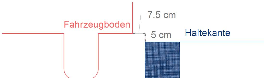
Abbildung 1: Maximal zulässiges Spaltmass zwischen Fahrzeugboden und Haltekante
