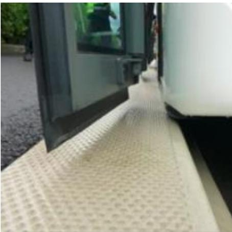
Künftige technische Entwicklungen bieten Potential zur Verbesserung der aktuellen Situation. So könnte durch Assistenzsysteme das Kneeling automatisch an die effektive Haltekantenhöhe angepasst werden. Dies würde teure Investitionen in Betonplatten zur Vermeidung von Spurrinnen hinfällig machen.
