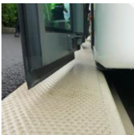
Figure 12: Agenouillement au niveau de la bordure d'accostage haute (photo: canton de Bâle-Campagne)
