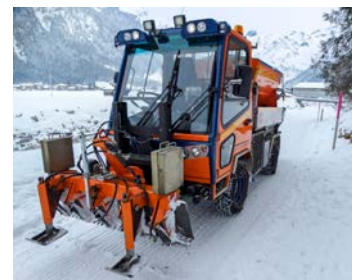
Abb. 17 Schmalspurfahrzeug beim Unterhalt von Winterwanderwegen
