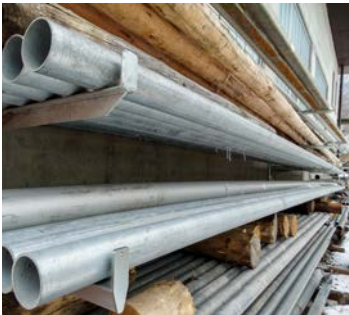
Abb. 14 Metallstangen, Länge 6 m, Durchmesser 2 Zoll – auf Vorrat, nach Bedarf zum Abschneiden
