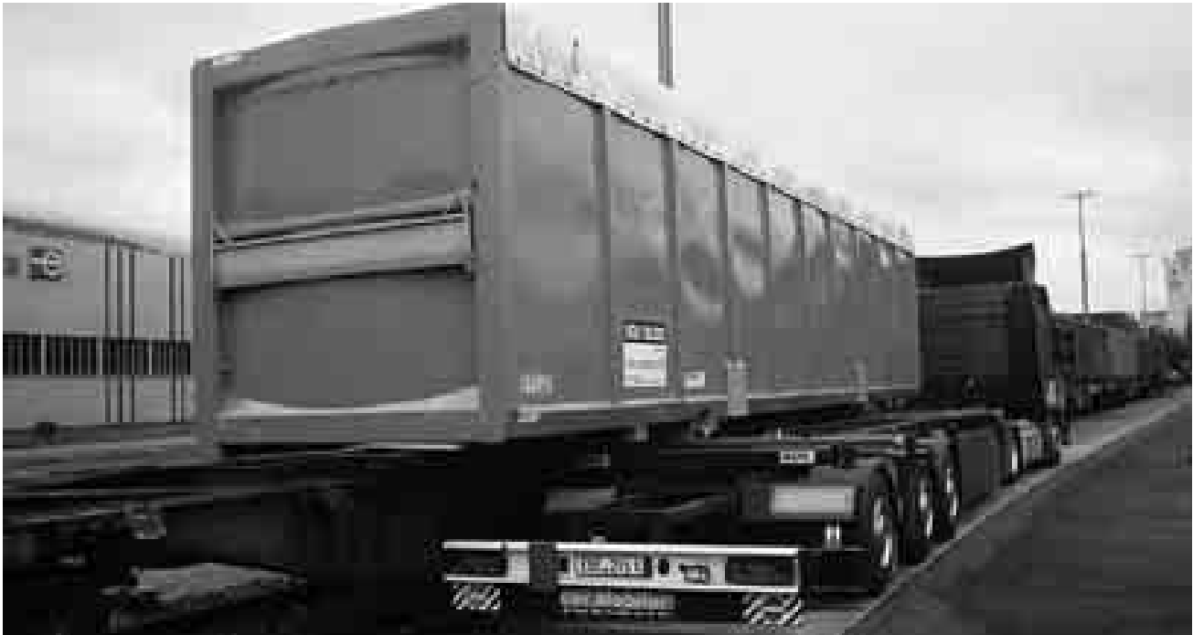
Transfer eines Schnitzel-Containers zwischen Lastwagen und Bahn (Fotos: Borregaard)
