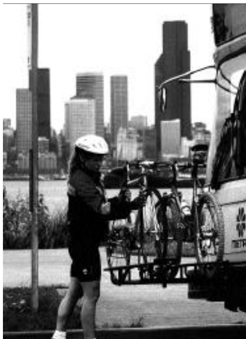
ILLUSTRATION 16 Support à vélos à l'avant d'un autobus urbain Seattle (Washington)
