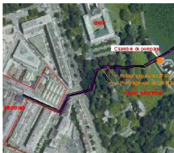
Réseau énergétique Lac-Nations Station de pompage, OMC et Serono
